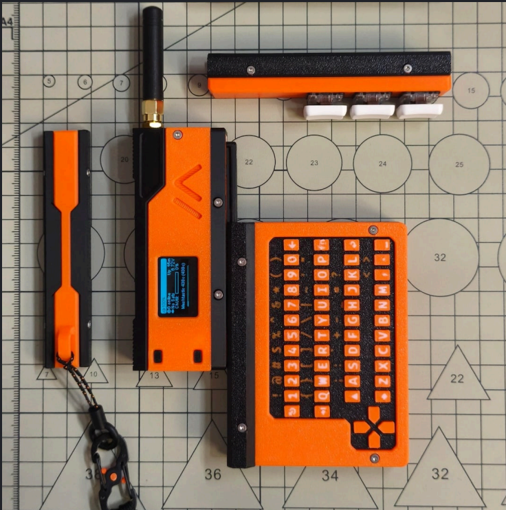
nœud modulaire imprimé en 3d (via r/meshtastic )
