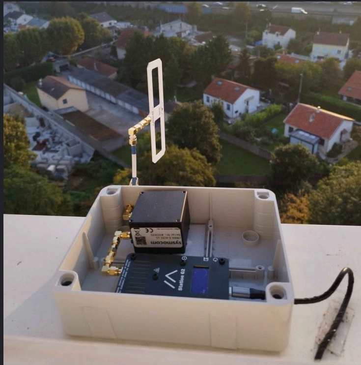
répéteur USB filtre cavité / antenne moxon (via Mesh IDF )
